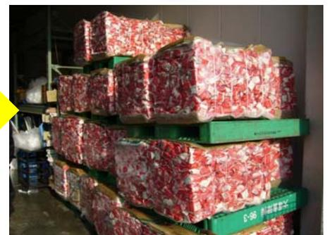
これは牛乳工場の様子です。各学校より収集した牛乳パックをまとめて圧縮し、梱包します。その後、牛乳パックは愛媛県にある製紙工場へと運ばれていきます。
