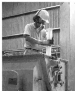
回収した蛍光灯を削いで中核処理
