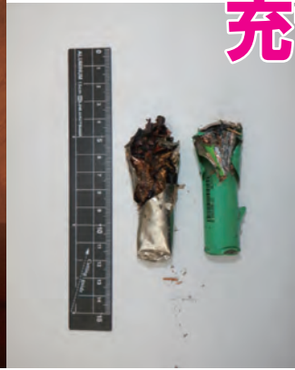
東北部クリーンセンターで発生した火災。破砕機本体で燃え上がる炎。 2021年1月12日発生（写真左） 発火したリチウムイオン電池の例（写真右）
