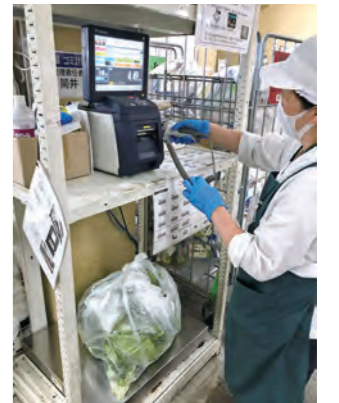
ごみの量を部門・分類別に計測できる廃棄物計量システム（計量器）を導入
