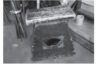
この踏み台、釘1本使わず、木組みで作られている。
