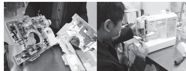
コンピュータミシンの内部 修理依頼のミシンの糸の調子を確認
