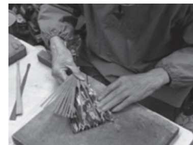
芯紙の隙間へ中骨を差し込む「中付け」の工程
