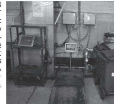
中央の計量器で生ごみの重さを量り、その後生ごみ処理機に投入する
